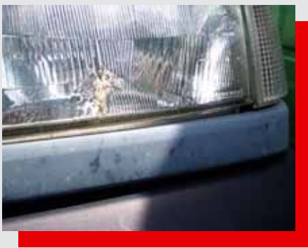
Optique percé : indépendant de la taille du dommage.
