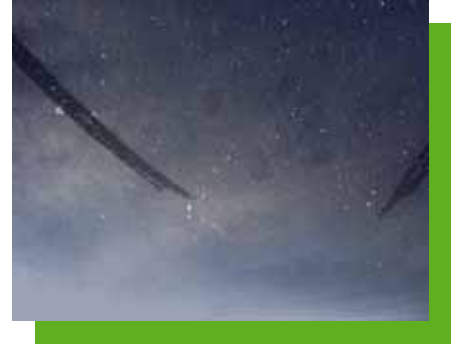
Impacts de pierre sur la surface du pare-brise sans fissures et dont le nombre ne nuit pas à la vue du conducteur lors de conduite nocturne ou sous la pluie.
