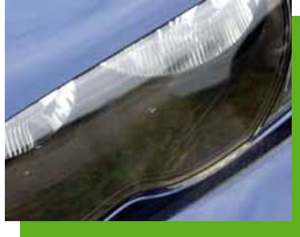
Légers impacts de pierre sur la surface des optiques.
